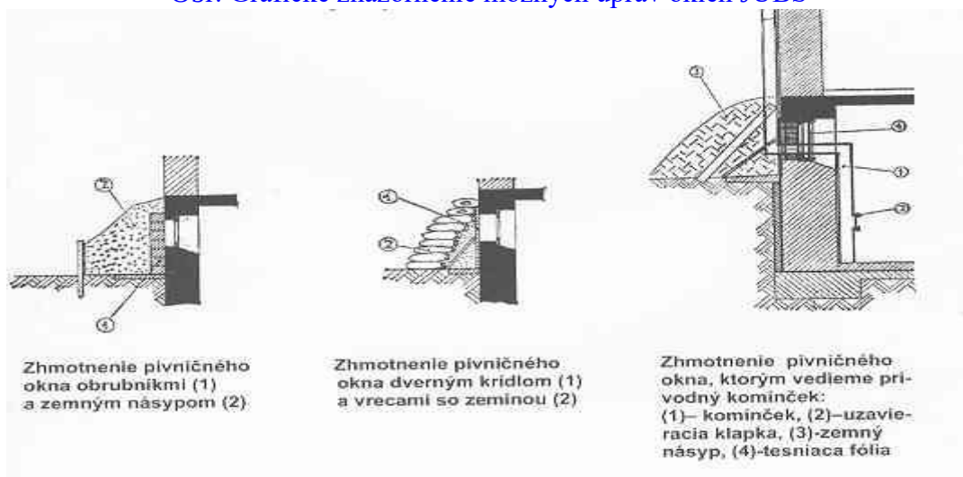
Obr. Grafické znázornenie možných úprav okien JÚBS
